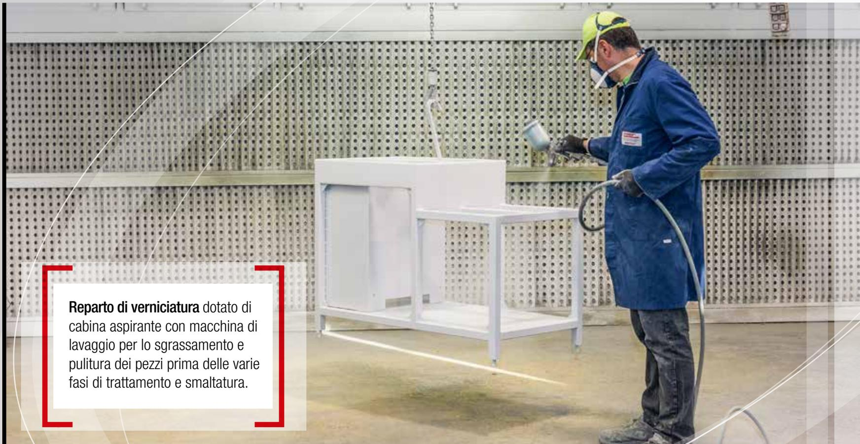
**Reparto di verniciatura** dotato di cabina aspirante con macchina di lavaggio per lo sgrassamento e pulitura dei pezzi prima delle varie fasi di trattamento e smaltatura.
